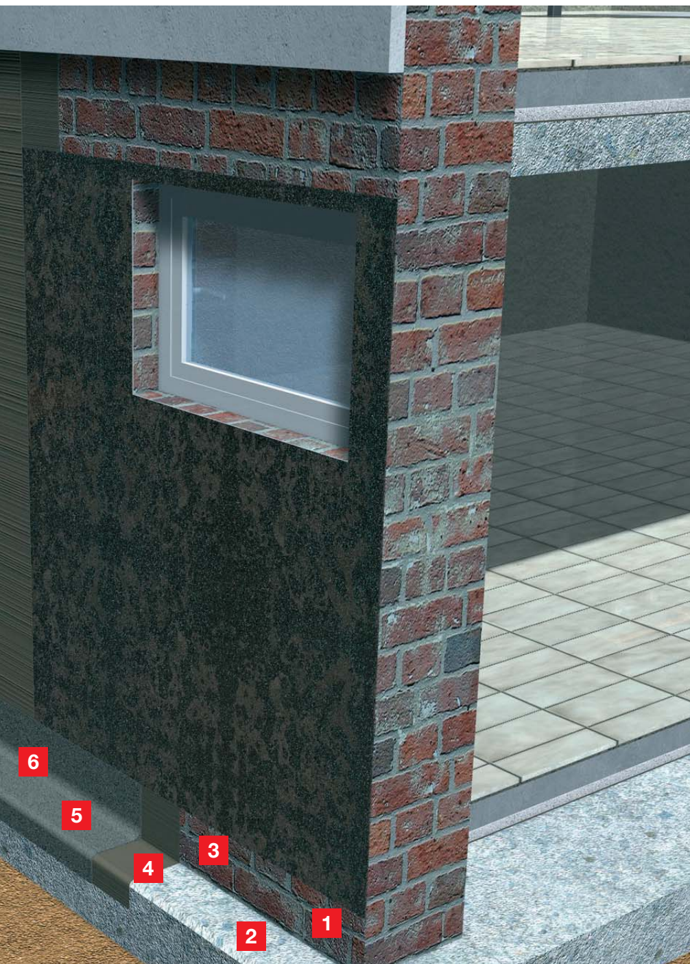
9 Schutz der trockenen Abdichtung Nach Durchtrocknung (zu prüfen an Referenzproben), die gesamte Abdichtung mit dem Remmers DS-Systemschutz schützen.
